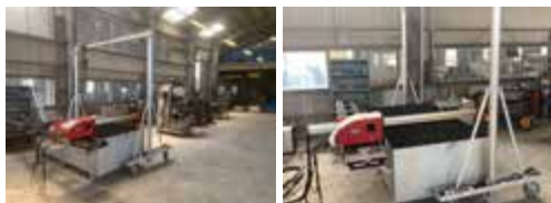
プラズマ切断機
